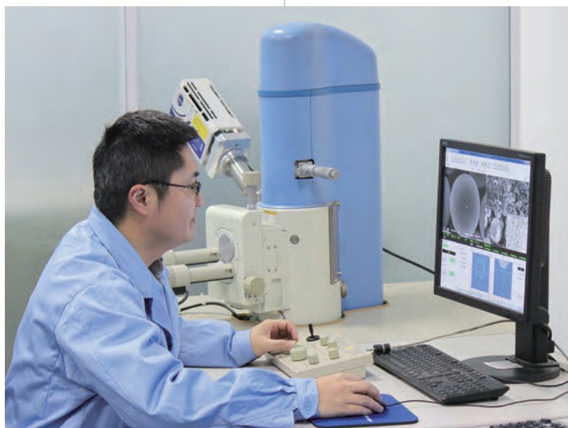
严开祺在进行空心玻璃微球的扫描电子显微镜观察
